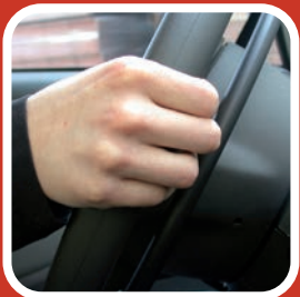
B. Den Gasring nach Armaturenbrett drücken
